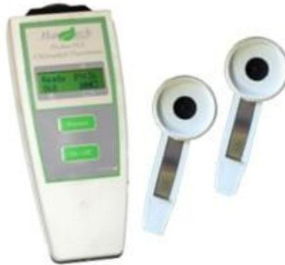
Figura 12. Fluorómetro portátil marca Pocket-PEA (Hansatech, UK) y pinzas de  $10 \text{ cm}^2$  que permiten pre-acondicionar la superficie foliar a la oscuridad.
