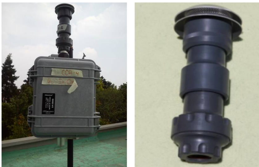
Figura 12. MiniVol y cabezal PM2.5.
