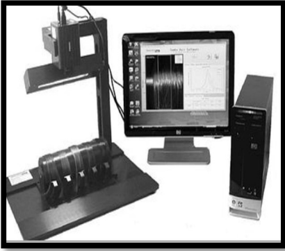
Figura 9. Equipo para determinación de brillo en cabello.
