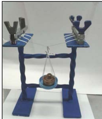
Figura 4. Equipo para evaluar resistencia con pesa de 200 g
