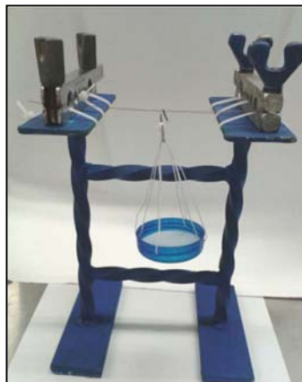
Figura 3. Montaje del equipo para evaluar resistencia.
