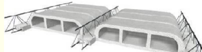
Sistema de Vigueta y Bovedilla
