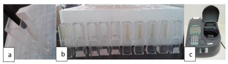
Figura 31. Desarrollo de la prueba de transparencia de las películas modelo: a) Colocación de la película en la celda de espectrofotómetro, b) Celdas con Películas modelo, c)
