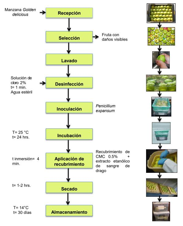
Figura 27. Diagrama de proceso de aplicación de RC.
