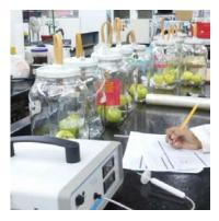
Figura 38. Determinación de la respiración de los frutos por un analizador de gases.
