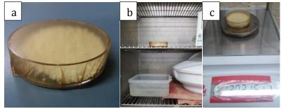
Figura 32. Desarrollo de la permeabilidad de vapor de agua de las películas modelo: a) Celda de permeación con la película modelo y dentro de ella el material desecante, b) Cámara de ambientación, c) Medición de la ganancia de peso de la celda de permeación.
