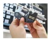
Figura 30. Determinación del espesor de las películas modelo por un micrómetro.
