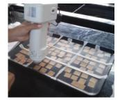
Figura 29. Determinación de color en películas modelo por el colorímetro.
