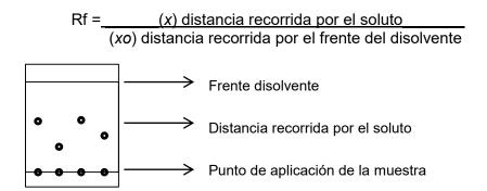
Figura 41. Relación de las distancia para el cálculo del factor de retención (Rf).
