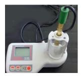
Figura 35. Potenciómetro para la determinación del pH de los frutos.
