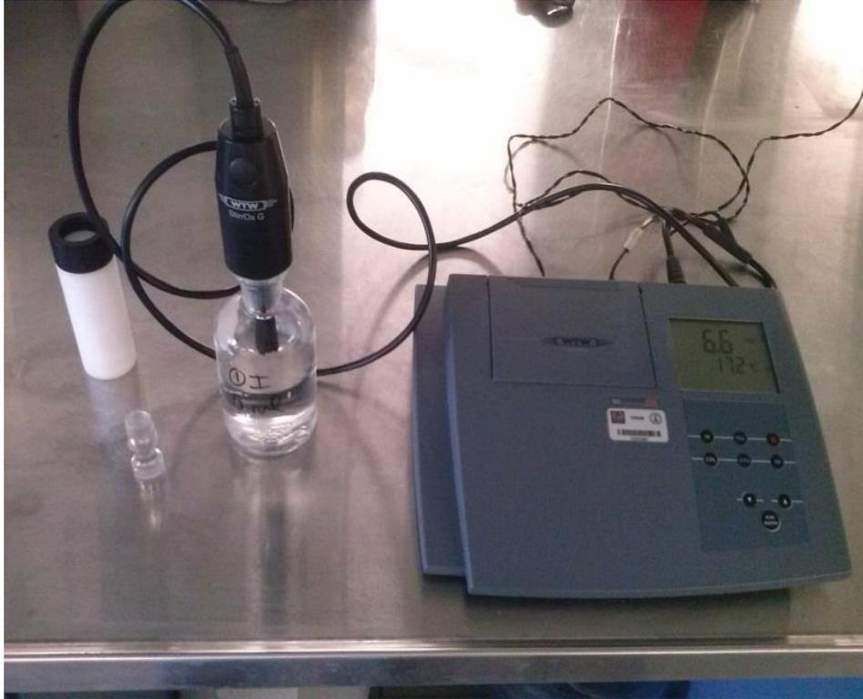
**Figura 3.5 Medición de oxígeno disuelto final.**
