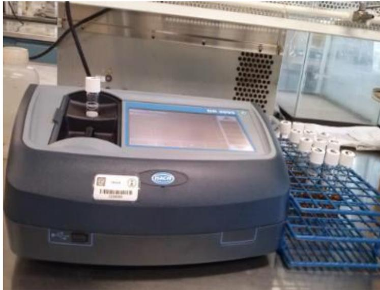
**Figura 3.15 Espectrofotómetro para medir el Fósforo Total.**
