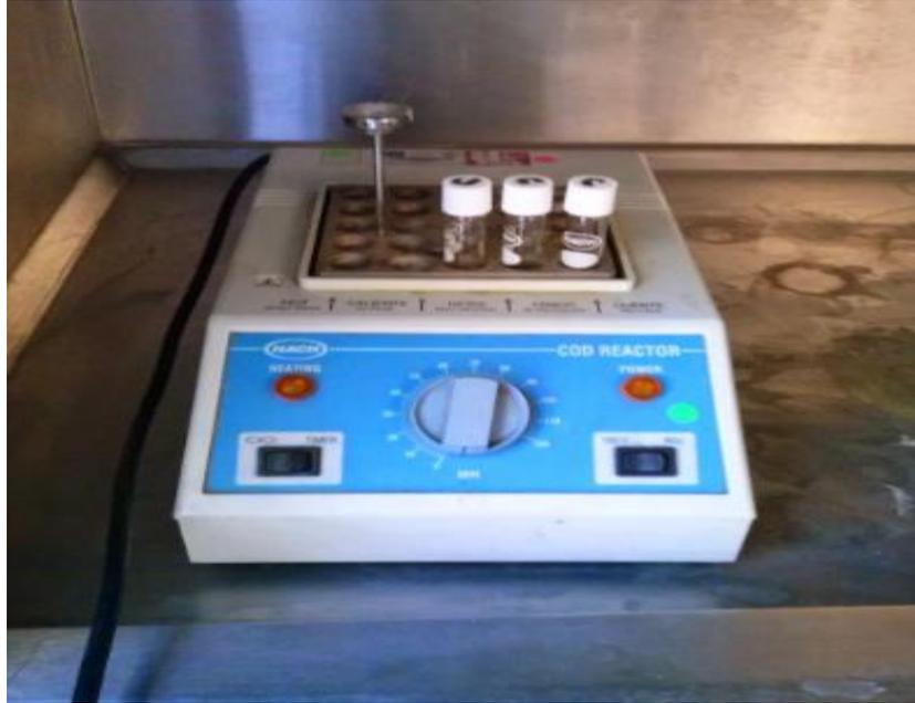
**Figura 3.13 Viales colocados en digestor**
