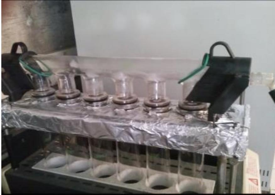
**Figura 3.9 Equipo armado para comenzar digestión.**
