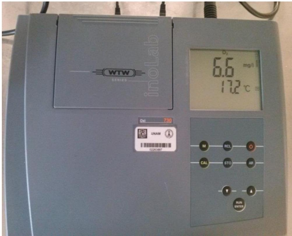
**Figura 3.3 Oxímetro utilizado para medir el oxígeno disuelto.**
