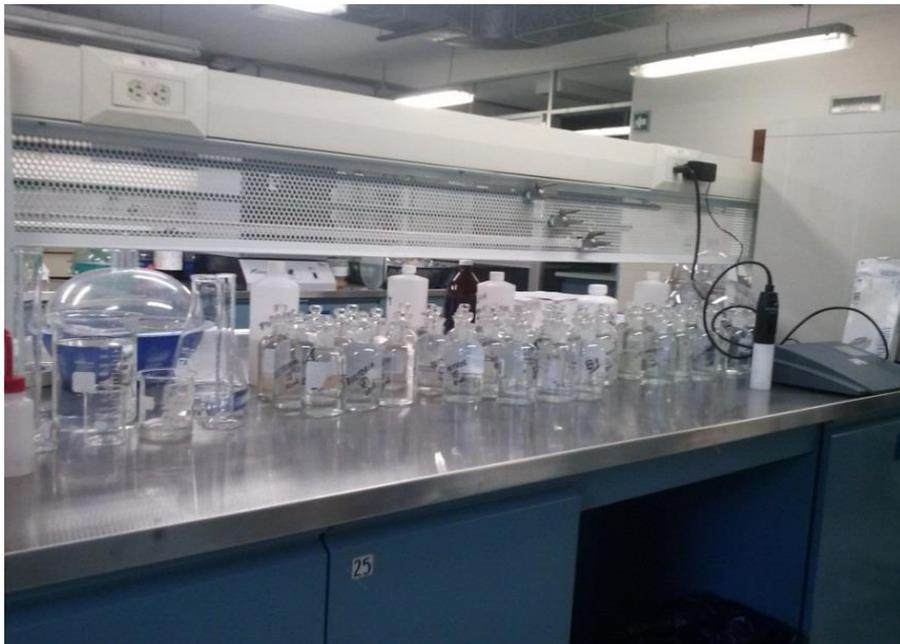
**Figura 3.2 Frascos Winkler con muestra y agua de dilución.**
