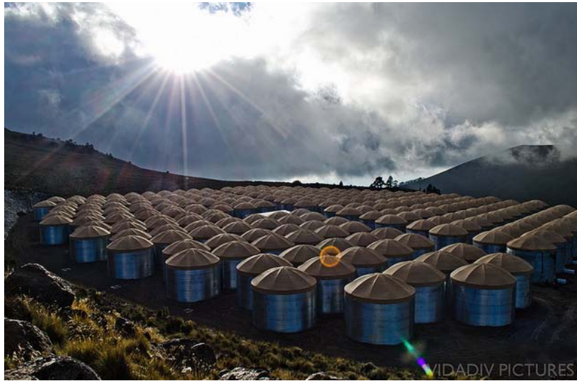
Figura 1.10: Fotografía del observatorio HAWC, se muestran los 300 tanques que contienen agua y los fotomultiplicadores. En el centro del arreglo se encuentra el centro de electrónica.
