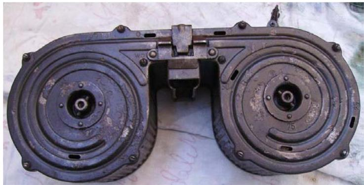
**Figura 1.14** Cargador helicoidal capaz de albergar hasta 150 cartuchos. (Fuente: Municion.org)
