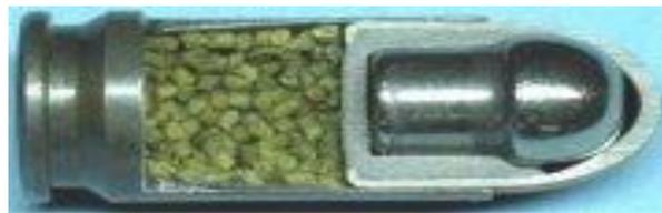
**Figura 5.1.** 9x18 Makarov con envuelta y núcleo de acero. Bala de deformación forzada: De punta hueca con un inserto metálico que al impactar penetra en el núcleo forzando la expansión. Adicionalmente, sobre objetos duros, el núcleo potencia la capacidad perforante. (Fuente: Municion.org)
