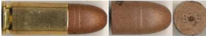
**Figura 5.4** Cartucho con bala frangible. De material cerámico macizo, al impactar se convierte en una pequeña nube de polvo. Bala muy ligera, marcada BB en la base. (Fuente: Municion.org)
