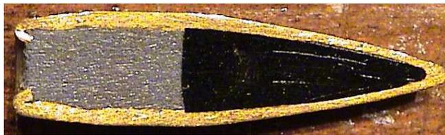
**Figura 5.3.** Núcleo desequilibrado: Balas con el núcleo formado por dos materiales de distinta densidad (plomo y aluminio o plástico) de modo que al dispararse vuelan en precario equilibrio. Al impactar, la parte posterior más pesada adquiere un momento y gira introduciéndose girando en el blanco. (Fuente: Municion.org)
