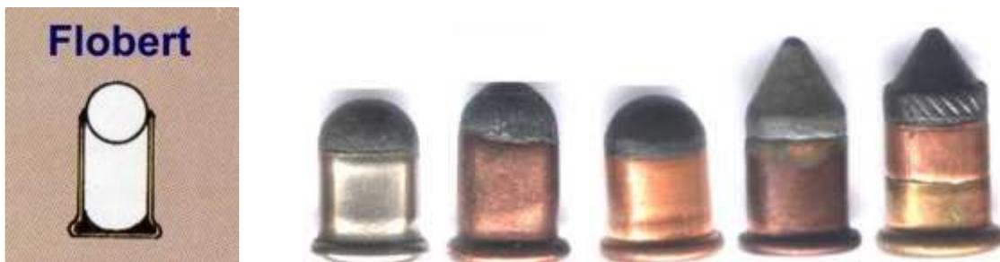
**Figura 1.9** Cartuchos Flobert utilizados en tiro de salón. Éste no contiene pólvora, únicamente fulminante. (Fuente: Municion.org)
