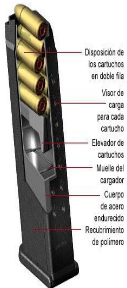
► **La Teja elevadora:** Una simple pieza plástica o metálica que permite que el muelle empuje uniformemente los cartuchos. En cargadores de doble hilera éste guía la introducción de los dos primeros cartuchos para que queden correctamente orientados.
