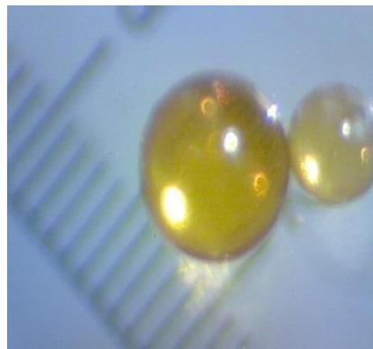
**Figura 4.6.** Tamaño de la resina R1 UAM Met, escala 0.1 mm.
