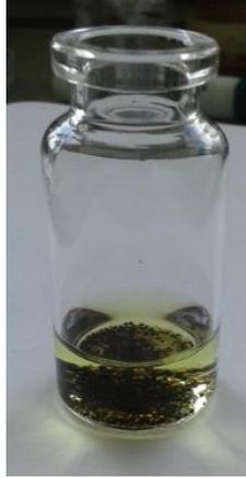
**Figura 4.24** Regeneración de la resina R1 UAM Sb con hidróxido de amonio al 28 %.
