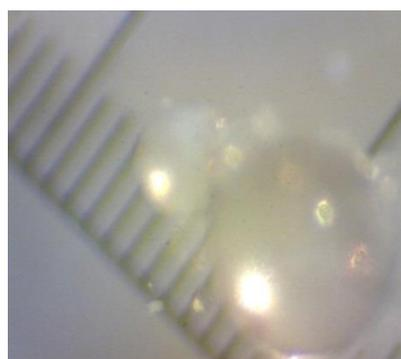
**Figura 4.2.** Tamaño de la resina R1 UAM (escala 1 mm)
