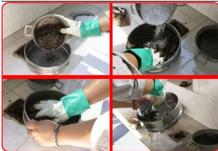
Figura 2.17. Muestras obtenidas de recortes de roca generados por la barrera (tomado de http://www.geoestratos.com.mx/web13/index.php?option=com_content&view=category&id=22&Itemid=214&lang=es ).
