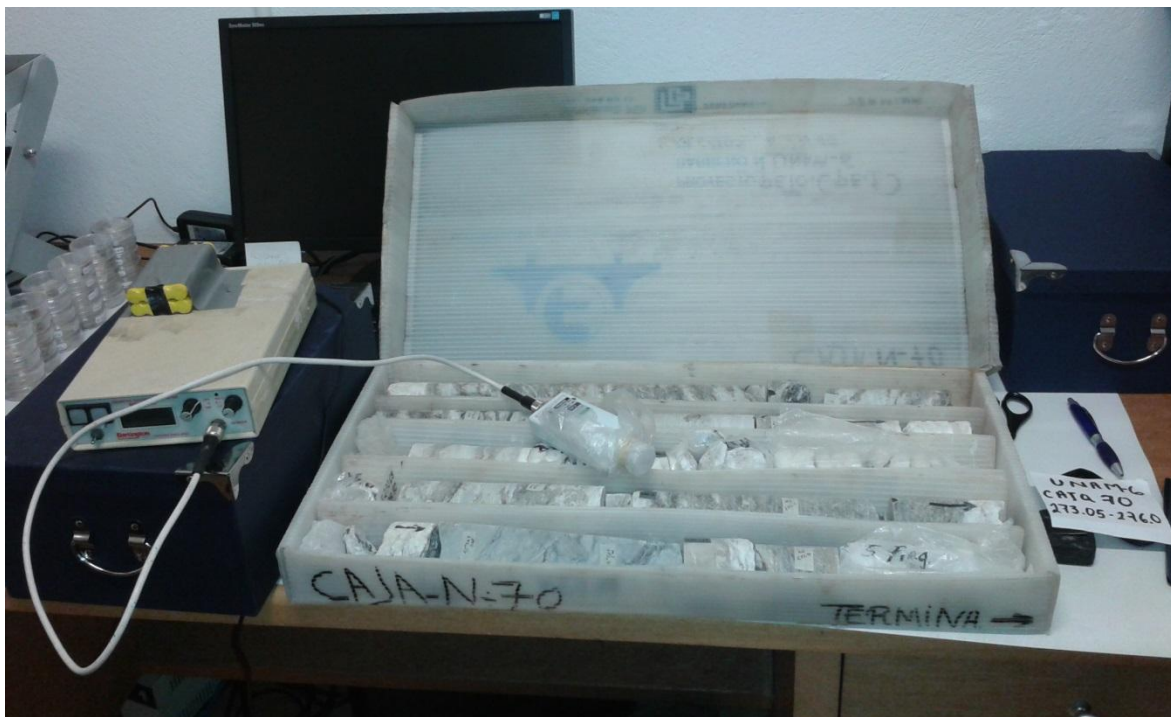
Fig. 5.1. Núcleos acomodados con respecto a su profundidad para obtener su susceptibilidad magnética con el equipo Bartington MS2.
