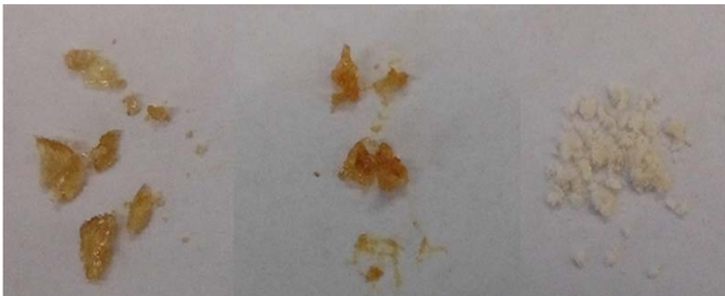
Figura 29. Cristales obtenidos del ligante diclorado. De izquierda a derecha, cristal en mezcla 7:3, Tol / Hex, cristal en dioxano y materia prima procedente de la reacción en ausencia de disolvente en un sonicador.
