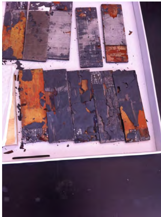
Figura 3. Capa TEOS fracturada debido a la dilatación del cobre.
