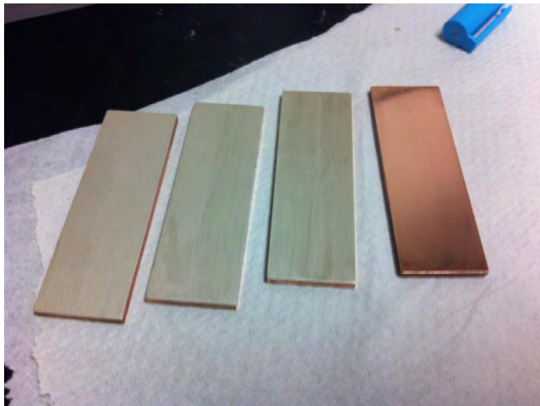
Figura 2. Placas de cobre con recubrimiento de plata.
