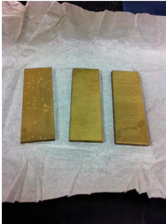
Figura 4. Electrodo de cobre con recubrimiento de plata y oro.
