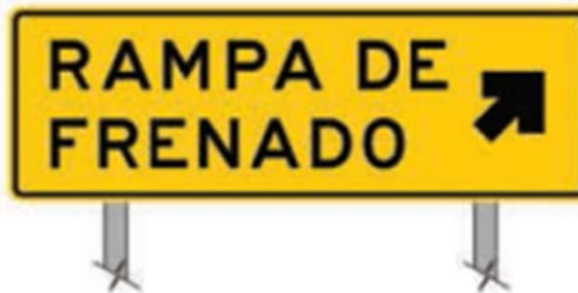
Figura 13: Señal SID 9 ó SID 11 "Rampa de frenado"
