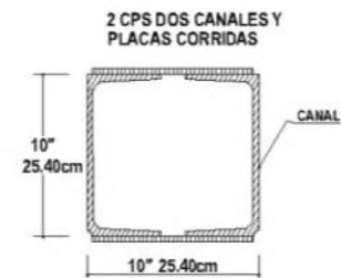
COLUMNA CL-1 VIGA EJE 3,4, 5 Y 6 S/E
