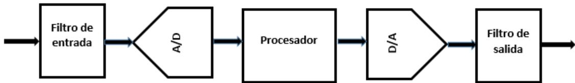
Figura 2.1: Arquitectura básica de un radio definido por software.
