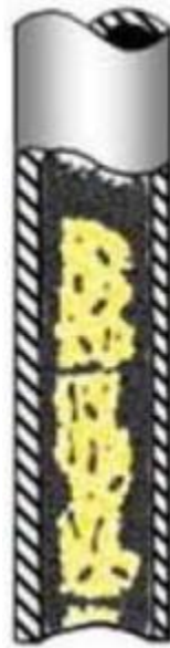
Figura 4.26. Flujo transicional en tuberías verticales.
