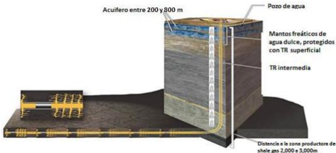
Figura 1.6. Mostrando una terminación de un pozo horizontal con fracturamiento múltiple.
