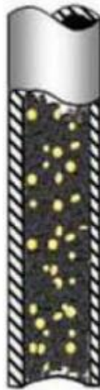
Figura 4.24. Flujo burbuja donde es posible observar al gas como fase dispersa en forma de pequeñas burbujas.
