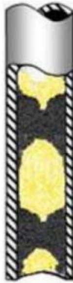
Figura 4.25. Flujo bache donde se observan las bolsas de gas en forma de bala viajando de manera continua, ocupando casi en su totalidad el diámetro de la tubería.
