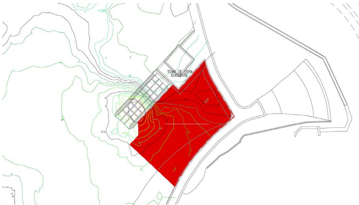
Figura 15. Tercera etapa de dragado.
