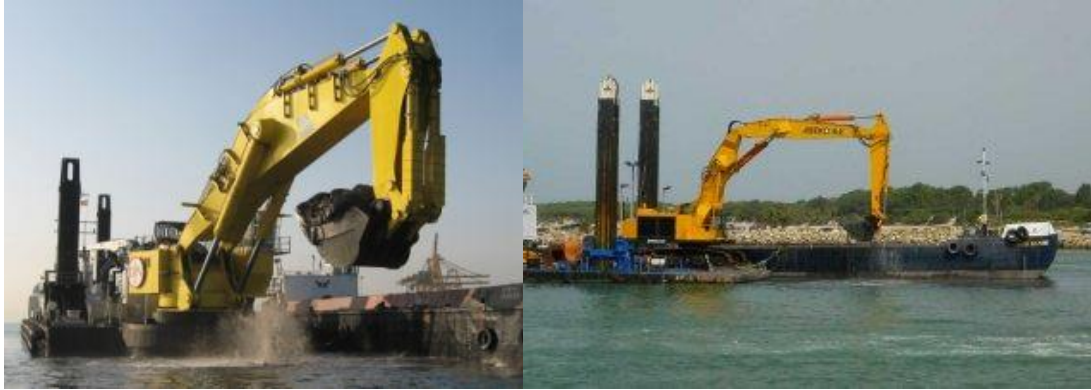
Figura 8. . Ejemplos de dragas de pala.
