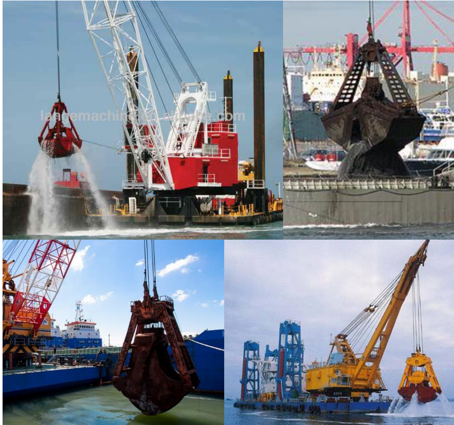
Figura 7. Ejemplos de dragas de cuchara.
