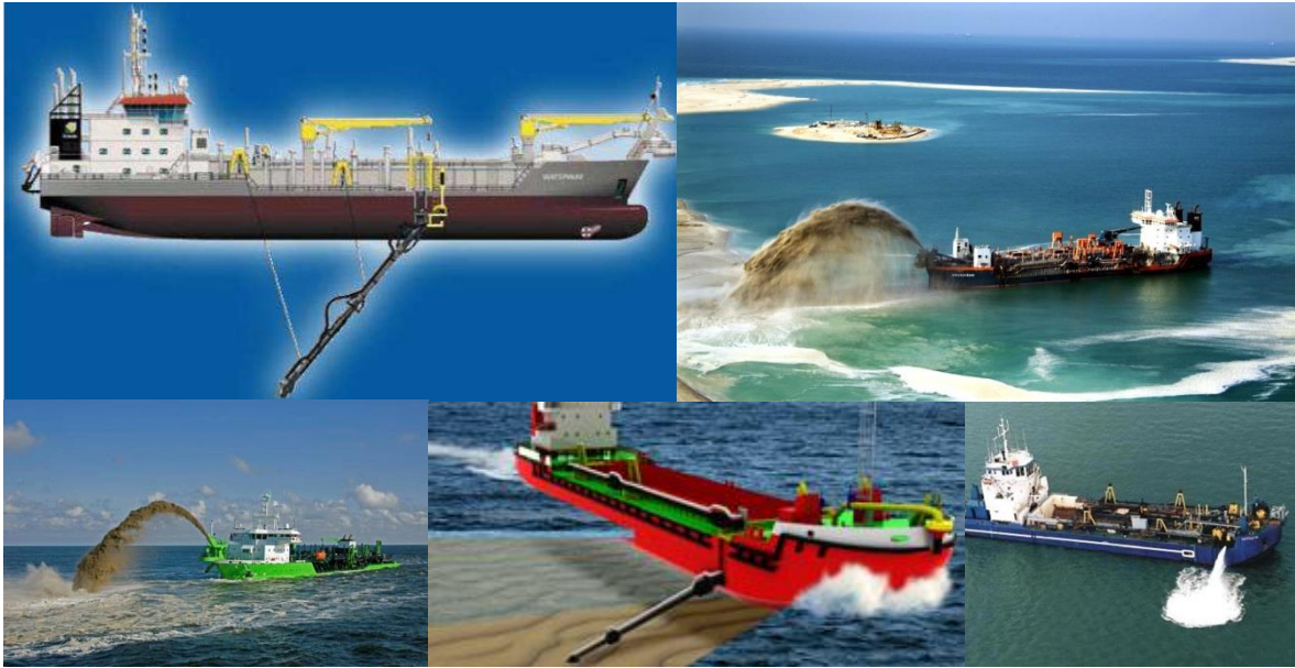
Figura 10. Ejemplos de draga de succión en marcha.
