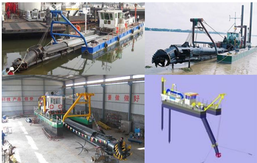
Figura 11. Ejemplos de dragas de cortador.
