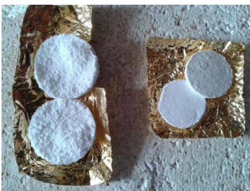
**Figura 10. Material obtenido después de la síntesis. Del lado izquierdo  $NaMgF_3:Tm$  y de lado derecho  $KMgF_3:Tm$ .**
