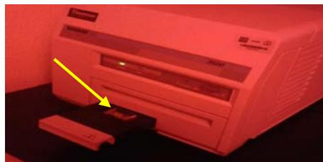
**Figura 11. Equipo Harshaw 3500 TLD, la flecha indica la posición de la plancheta de calentamiento donde se colocan las muestras.**
