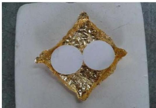
**Figura 9. Pastillas de la mezcla de reactivos sobre la lámina de oro.**
