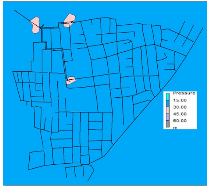
Fig. V-5 Distribución de presiones con sectorización y control de presiones - Caso 2
