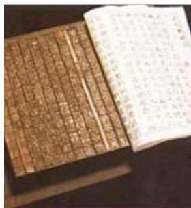
Ejemplos de impresión China( 200 d. C.), a partir de letras e imágenes talladas en relieve en bloques de madera. http://bit.ly/1Wbv7It
