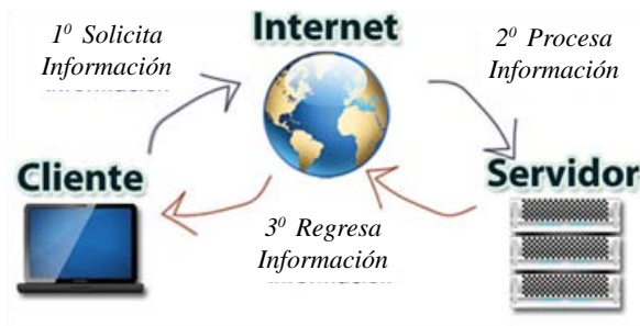
Funcionamiento de un hosting. http://bit.ly/21bmr98
