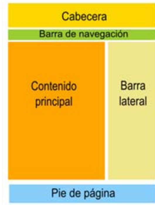
Esquema que señala las partes básicas que componen a una página web. http://bit.ly/1L4LnJe
