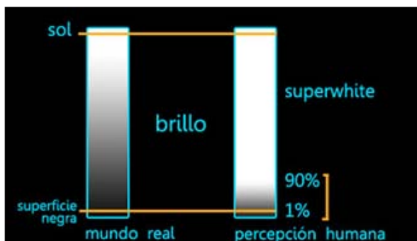
Gamma se refiere al nivel de contraste entre los valores grises de gama media de una imagen. http://bit.ly/IQDjCWA
