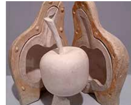
Técnica de cera perdida. http://bit.ly/1Kwcf9
