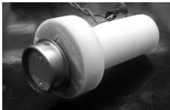
FIGURA 3.1: Fotoresistencia montada en soporte de teflón.
