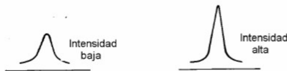
Fig. 2.19 Relación de Efecto Stokes y anti-Stokes con temperatura.
