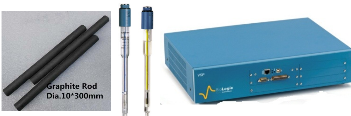
Fig. 2.36 De Izq. a Der. Barras de grafito, electrodos de referencia Hg/HgSO_4 y Hg/HgO , y Potenciostato-Galvanostato
