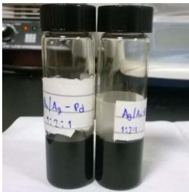
Fig. 2.11 Nanopartículas sintetizadas con control de temperatura y PVP como surfactante.
