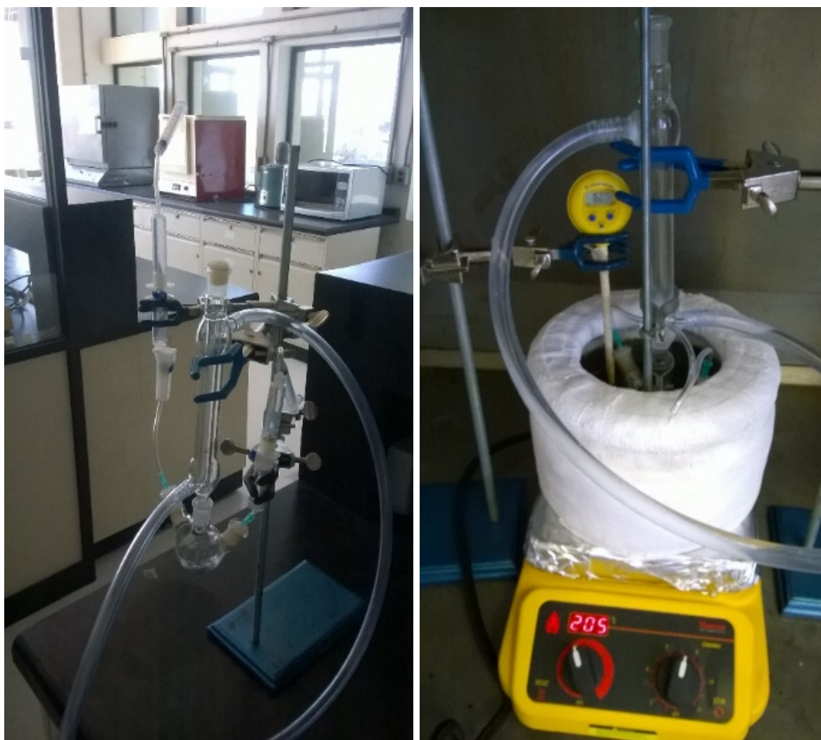
Fig. 2.8 Dispositivo para Síntesis por el Método del Poliol con control de temperatura.
