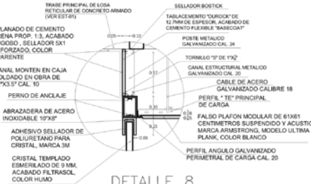
DETALLE 8 ACOT. EN METROS ESC: 1:20 A-04
