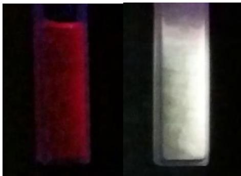
Figura 48. Disolución 0.0425 mM de  $\text{Cu}_4\text{L}_2\text{I}_4$  (**4**) a  $T$  ambiente (izquierda) y  $T$  de nitrógeno líquido (derecha) en  $\text{CHCl}_3$ .
