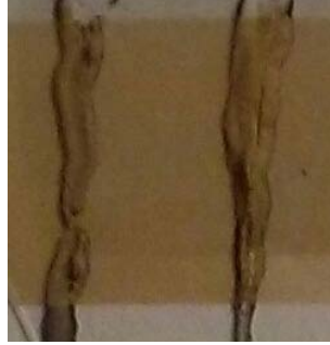
Figura 12: Muestra de MG-C_{60} , la parte gris corresponde a MG, la rojiza a C_{60} y las tiras plateadas corresponden a los electrodos de pintura de plata.
