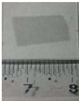
Figura 11: Muestra de MG, que corresponde a la parte de color gris, sobre cubreobjetos de vidrio de aprox 1.2 cm x 0.6 cm de área de MG.
