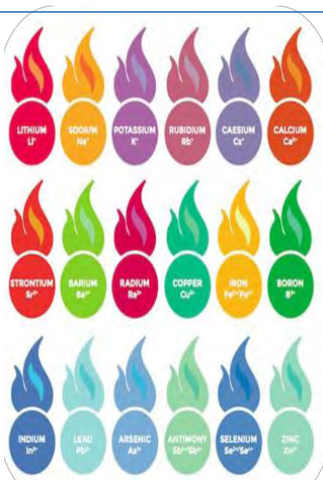
Imagen 5.2 Ensayos a la llama y la coloración de algunos cationes metálicos
