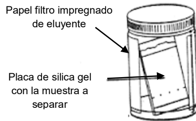
Imagen 4.2 Frasco de cromatografía con papel filtro impregnado de eluyente y placa de sílica gel con la muestra a separar.
