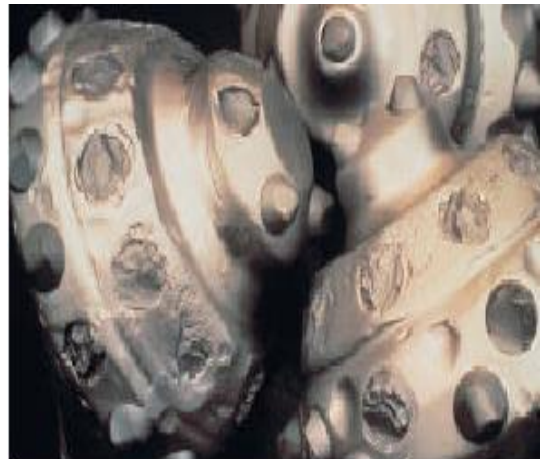
Figura 49 daño por dientes rotos.
