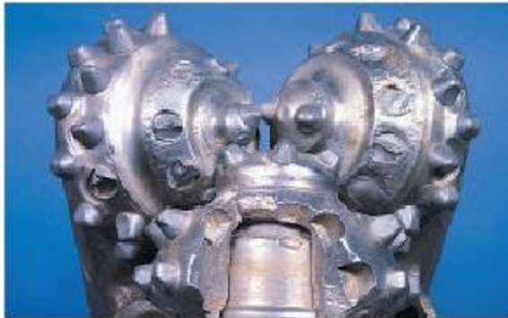
Figura 48 daño por cono roto en barrena tricónica.
