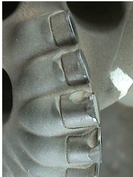
Figura 44 Desgaste por erosión
