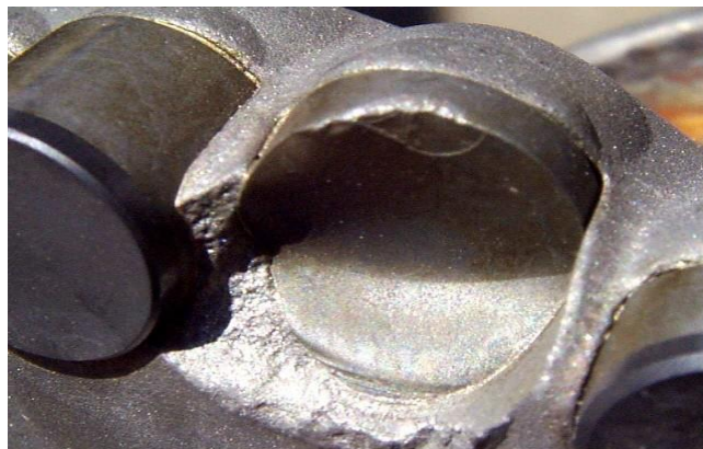
Figura 39 Falla de Adherencia
