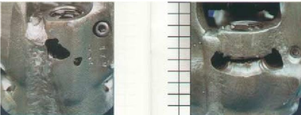
Figura 69 daño por lavado.
