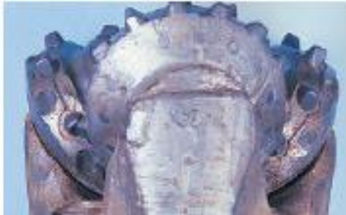
Figura 63 Daño por forzamiento de barrena
