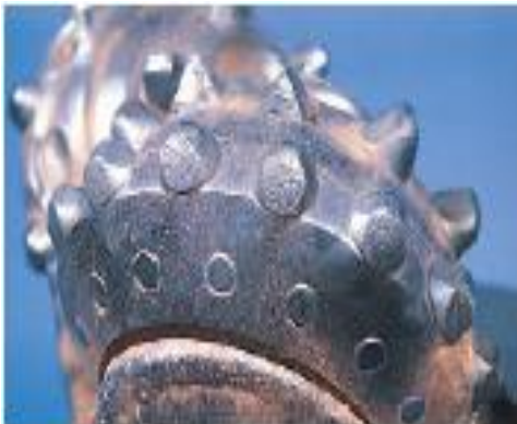
Figura 57 sobre calentamiento de una barrena
