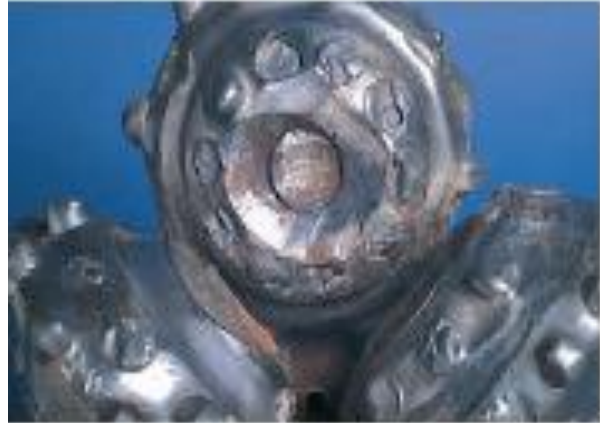
Figura 54 coroneado de una barrena tricónica.
