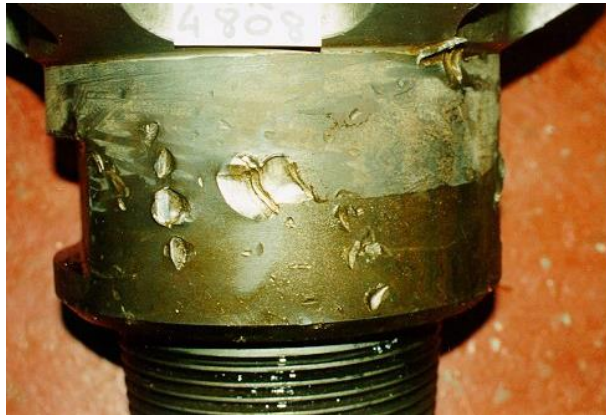
Figura 46 Desgaste por chatarra
