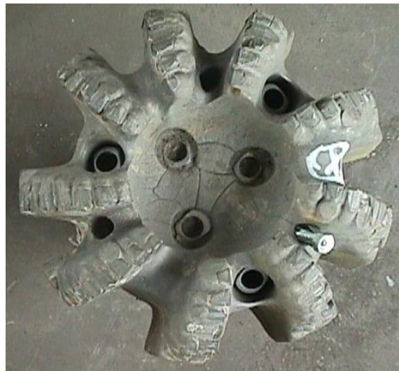
Figura 42 Desgaste en el centro
