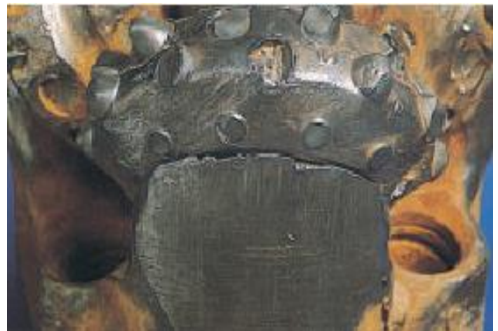
Figura 66 barrena con daño en la pierna.
