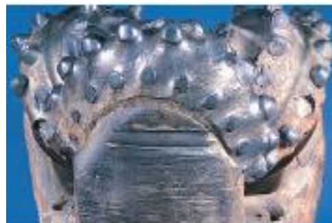
Figura 58 barrena con daño por chatarra.
