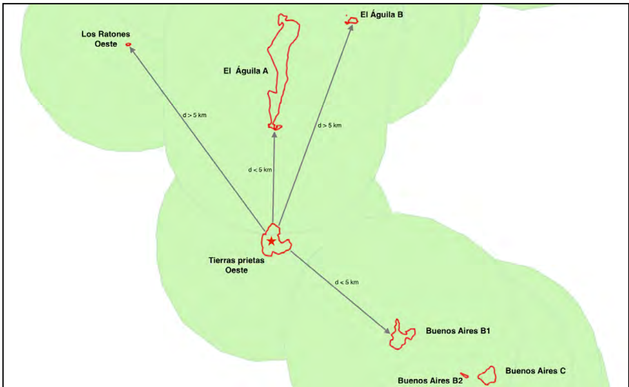
Figura 10. Esquema de la determinación de la conectividad de las colonias. Con base en el centroide de cada colonia se estimó la distancia de esta con el resto, y solo aquellas colonias cuya distancia entre ellas fue menor al máximo de dispersión de los PLCN (5 km) se consideraron como vecinas. El número de colonias vecinas determina el valor asignado de conectividad para cada colonia. En el ejemplo se observa la colonia focal “Tierras Prietas Oeste” (marcada con la estrella roja), la cual tiene dos colonias vecinas: “El Águila A” y “Buenos Aires B1”, por lo tanto el valor de la conectividad para esta colonia es de 2 colonias.
