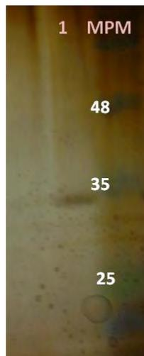
Figura 25. Gel de plata del extracto purificado presente en el medio de cultivo de *L. tarentolae* modificada con el gen de la silicateína. MPM: marcador de peso molecular, 1: muestra.
