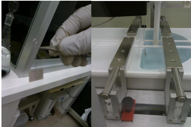
Figura 3.2. Izquierda: Plato de Wilhelmy antes de ser colocado en la balanza. Derecha: Barreras cerradas y plato de Wilhelmy colocado en la balanza
