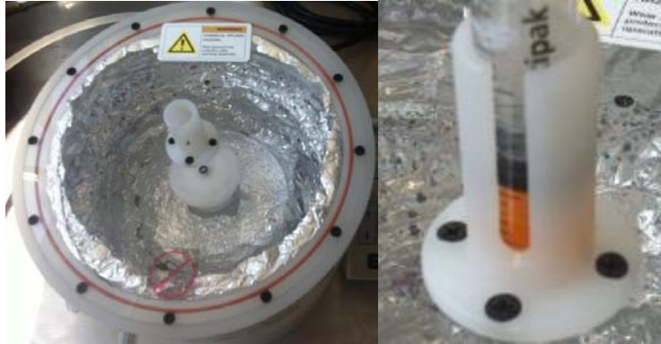
Figura 3.12. Izquierda: eje del spin coater; Derecha: porta sustratos
