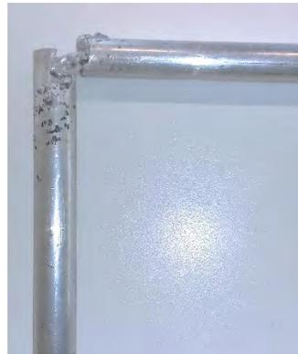
Figura 59. Cordón de soldadura 70[A]
