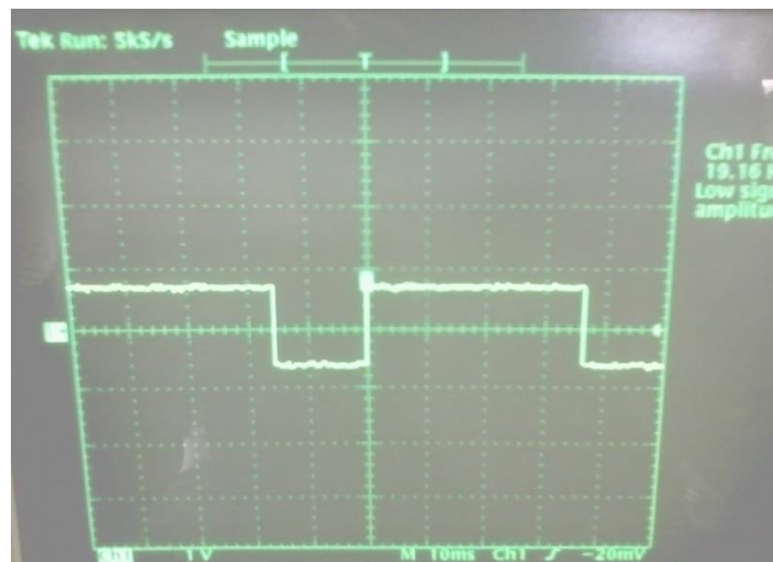
Figura 28. Señal AC cuadrada de entrada al sensor de EC.
