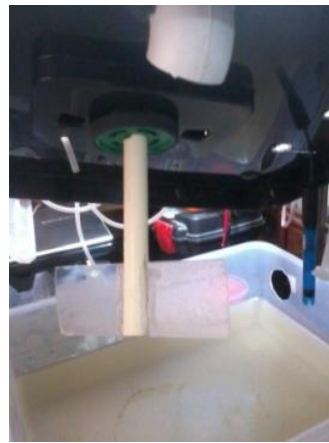
Figura 75. (a) Motor reductor de plástico. (b) Paletas para agitador.
