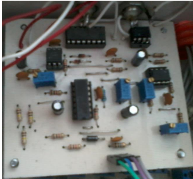
Figura 31. Implementación del circuito de acondicionamiento de señal de pH y EC.
