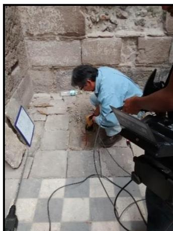
Figura 3.38 Exploración con videooscopio.
