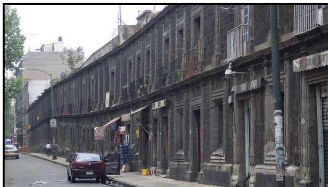
*Figura 3.10 Muestra de hundimientos diferenciales en la ciudad de México*
