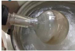
Figura 3.7. Purificación en rotavapor de reacción A10.
