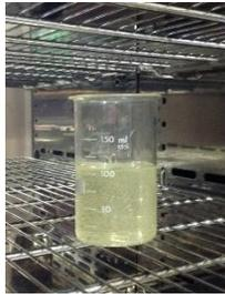
Figura 3.11. Resina epóxica acrilada pura A23 dentro del horno a 130 °C.
