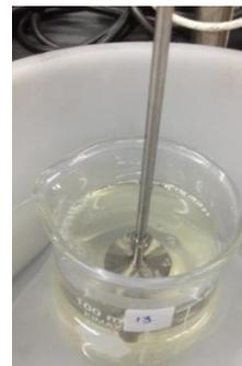
Figura 3.15. Medición de Viscosidad de UV-A13.
