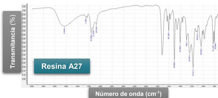
Figura 4.29. Espectro FTIR-ATR de resina A27.
