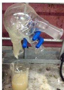
Figura 3.6. Extracción de resina epóxica acrilada pura A22 a temperatura de reacción.
