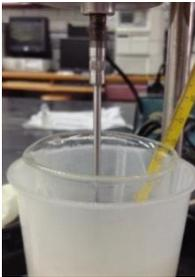
Figura 3.10. Determinación de viscosidad de resina A13.
