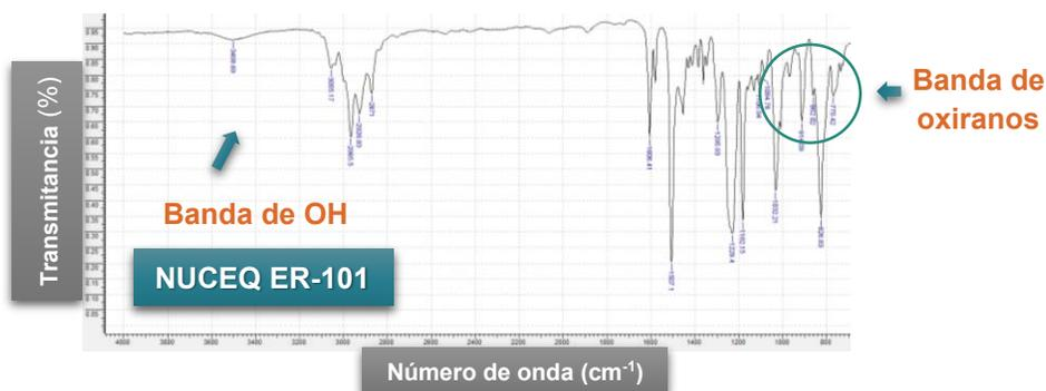
Figura 4.2. Espectro FTIR-ATR de LER.
