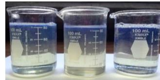
Figura 3.13. Barnices de curado UV elaborados con resinas epóxicas acriladas sintetizadas en el laboratorio. De izquierda a derecha son los barnices UV-12, UV-12M y UV-13 respectivamente.
