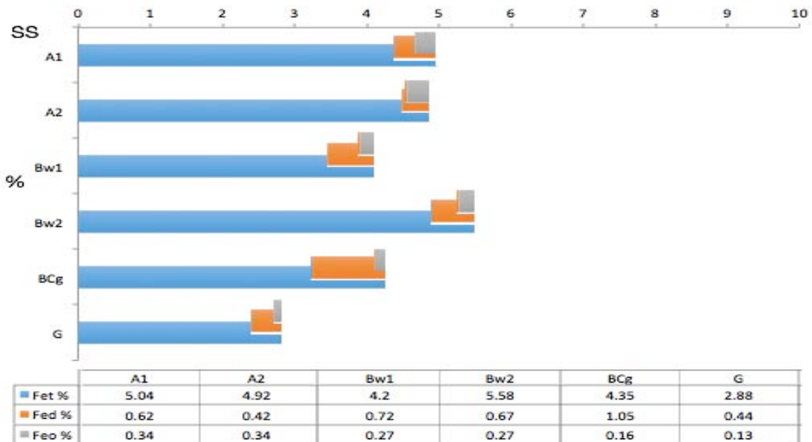
Figura 38. Perfil Simón Sarlat: comparación de los valores de Fe o con el Fe d y Fe d con el Fe t .
