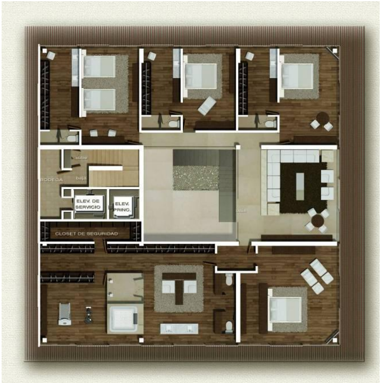
Ilustración 20. Sky House- Planta Alta (distribución propuesta)
