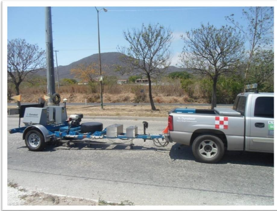
*Fotografía 3.2.1.1.- Medición de deflexiones con equipo HWD, km 1+500 cuerpo A.*
