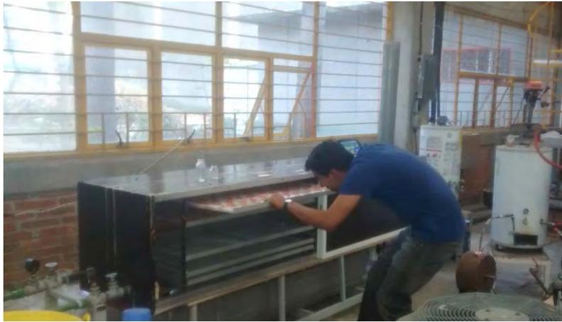
Figura 73 Fotografía de carga del alimento en la bandeja de pesaje.
