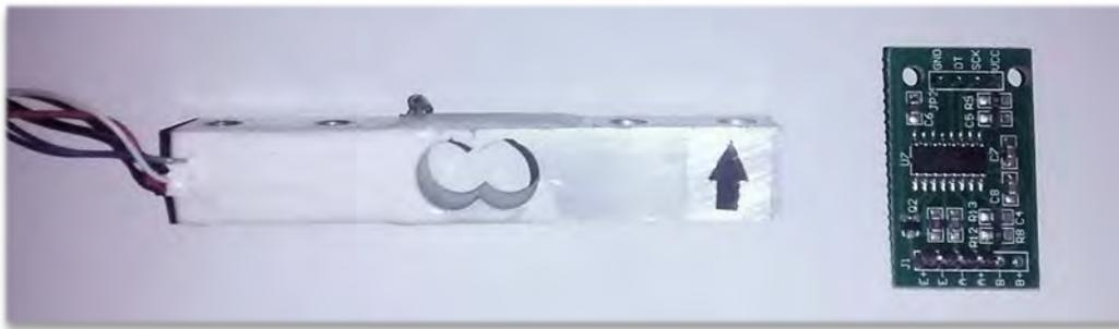
Figura 29 Fotografía de celda de carga de 20 kg y módulo HX711.
