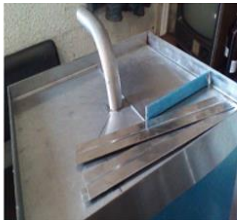
Figura 24. Conexión de cámara de secado con tubo colector mediante codo de acero inoxidable.
