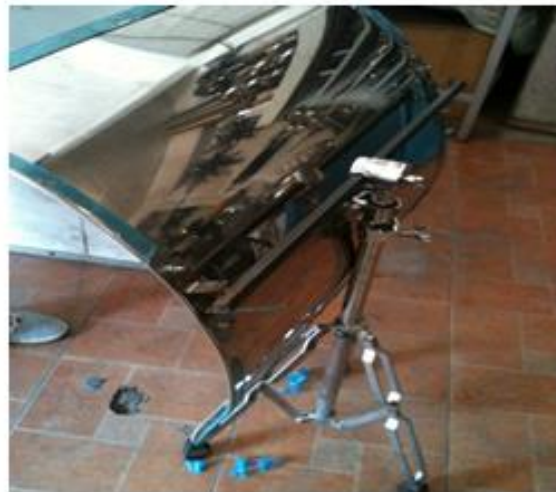
Figura 19. Base de la parábola y parábola con la base armada.
