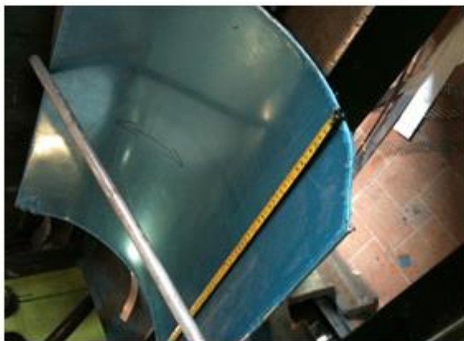
Figura 18. Parábola con profundidad de 15cm.
