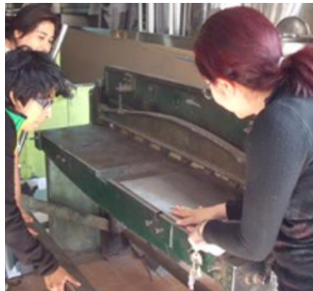
Figura 17. Corte de la lámina empleada para la realización de parábola.
