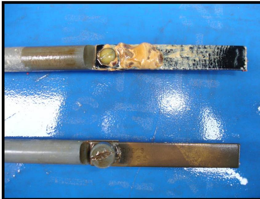
*Figura 1.8. Corrosión uniforme en sistema abierto en circulación<sup>15</sup>.*
