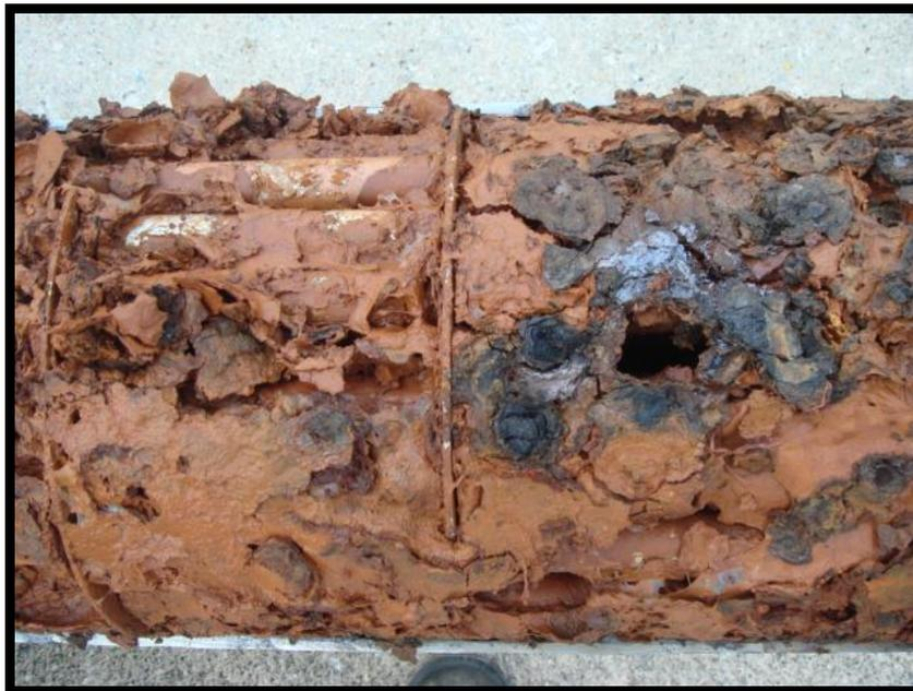
*Figura 1.5. Corrosión en intercambiador de un sistema de enfriamiento cerrado<sup>13</sup>.*
