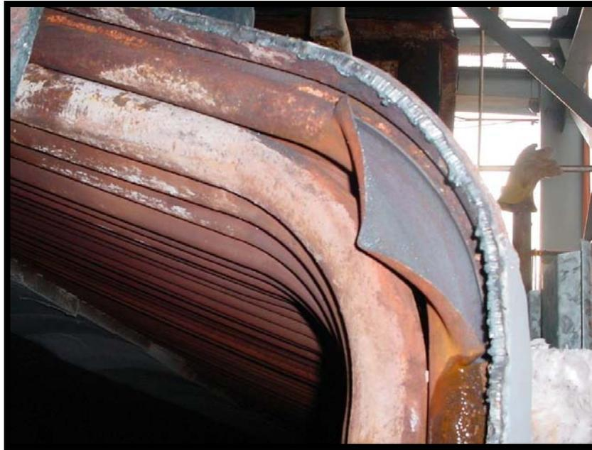
*Figura 1.6. Corrosión por esfuerzo (stress) en una caldera con presión alta<sup>14</sup>.*
