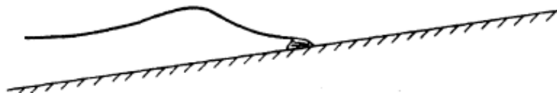
Figura 2-8 Rotura del oleaje tipo Surging, Modificado de CEM, 2003 y de Sorensen, 2006.
