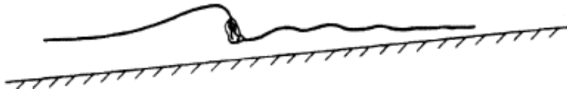
Figura 2-9 Rotura del oleaje tipo Collapsing, Modificado de CEM, 2003 y de Sorensen, 2006.
