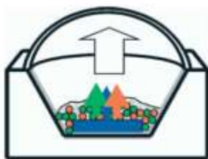
Figura 1.2. Diagrama de la luz emitida por un LED-chip con partículas de fósforo para la conversión de color.
