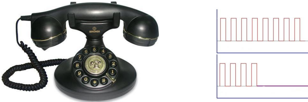
Figura 1.12 Marcación por pulsos
