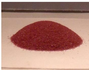
Figura 3.3. Preparación del indicador murexida en KCl
