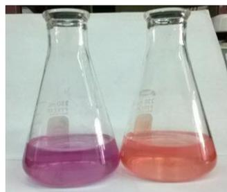
Figura 3.4. Formación del complejo  $\text{EDTA-Ca}^{2+}$  (izquierda), formación del complejo  $\text{Murexida-Ca}^{2+}$  (derecha)
