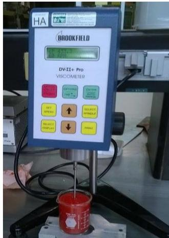
**Figura 3.5. Uso del viscosímetro Brookfield DV-II+Pro**
