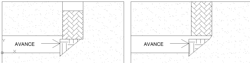
A) FALLA TIPO CHIMENEA
