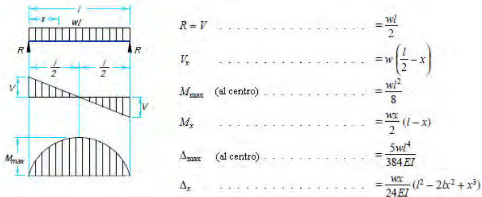
Viga simple con carga uniformemente distribuida
