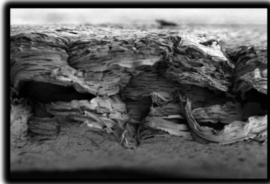
Figura 24. Micrografía electrónica de barrido de una, poli nanoestructura porosa (ácido láctico-co-glicólico) (PLGA) de la membrana. 37
