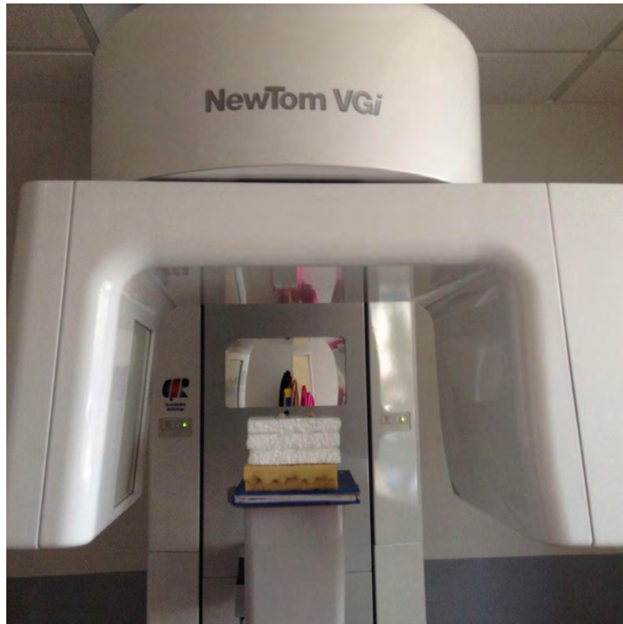
Fig. 48. La muestra de estudio en el tomógrafo Newtom VGi. ® (Fuente directa)
