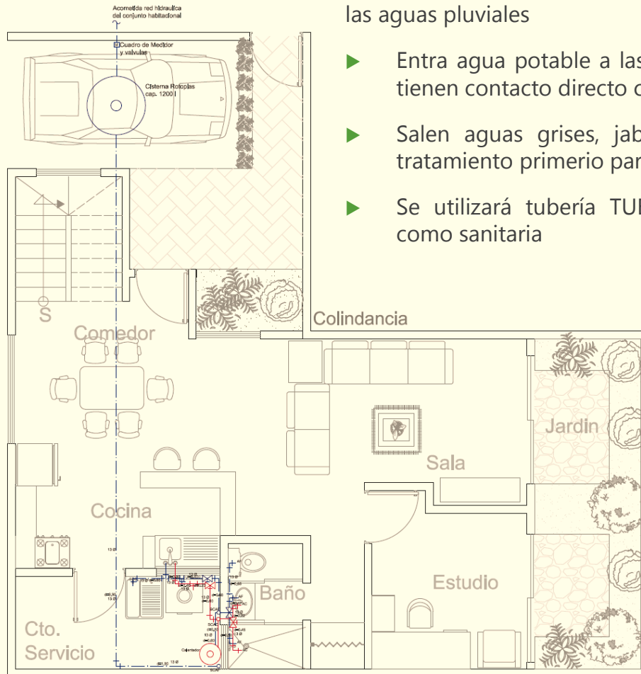
Instalación Hidráulica de Prototipo C
