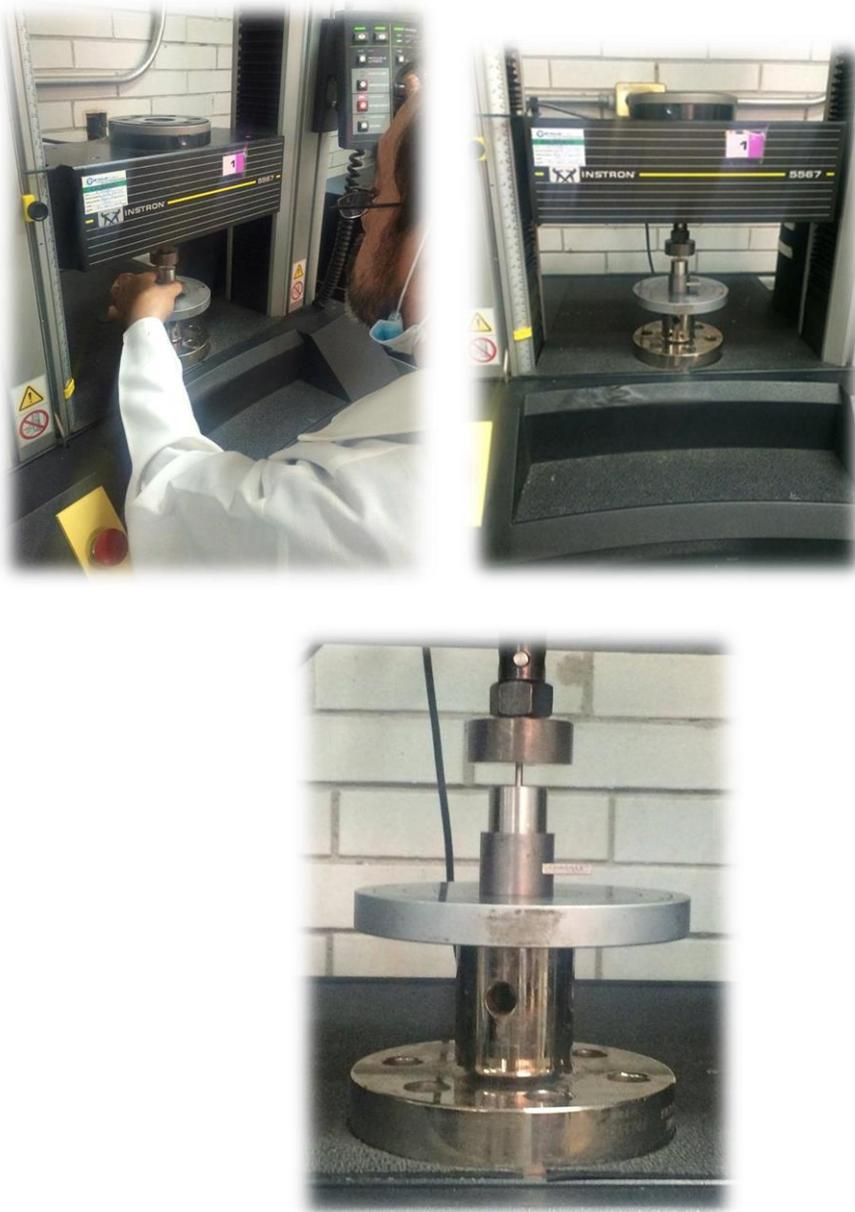
(Figura 18) Colocación de muestras en máquina de pruebas mecánicas.
