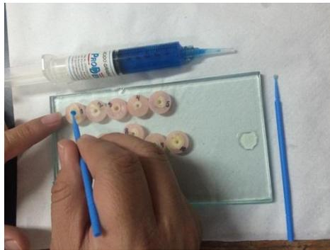
(Figura 13) Colocación de ácido grabador
