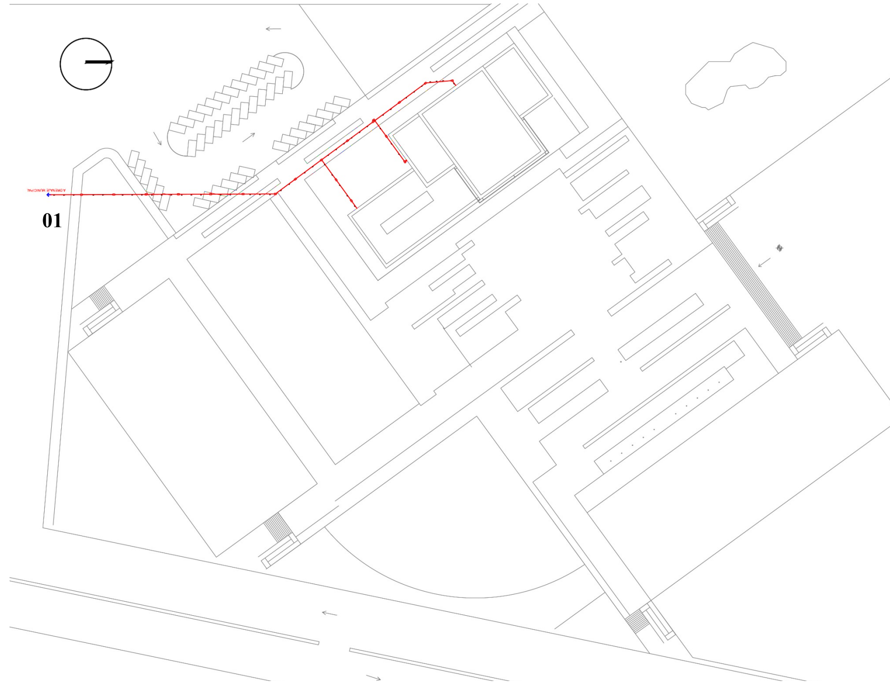
Instalación Sanitaria ( Conjunto) 01. Colector Municipal
